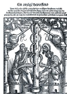
*Destillation mit spiralförmig gewundenen, dem Hermesstab ähnlichen Rohrverbindungen.*
